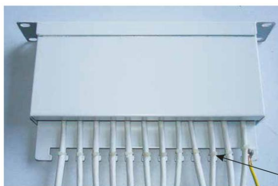
Fäst kablarna ordentligt med buntband för ytterligare dragavlastning.
