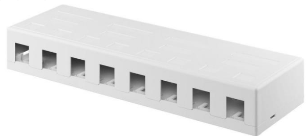
Uttagsbox för 8 x Keystone moduler, utanpåliggande montage. Storlek: 217x93x30 mm Art.nr. 452-16
