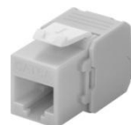
Nätverksuttag Cat6 STP LSA Storlek 80x80 mm Komplett nätverksuttag för anslutning enligt 568A eller 568B. Kan användas som infällt eller utanpåliggande nätverksuttag. Art.nr. 420-16
